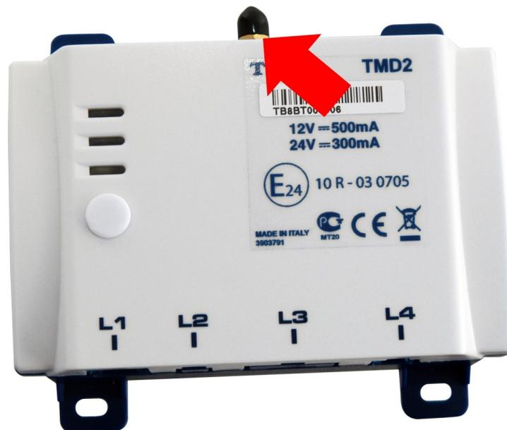
2. Insérer le connecteur de l'antenne GPS externe dans celui du dispositif en exerçant une légère pression, jusqu'à entendre un "clic".
