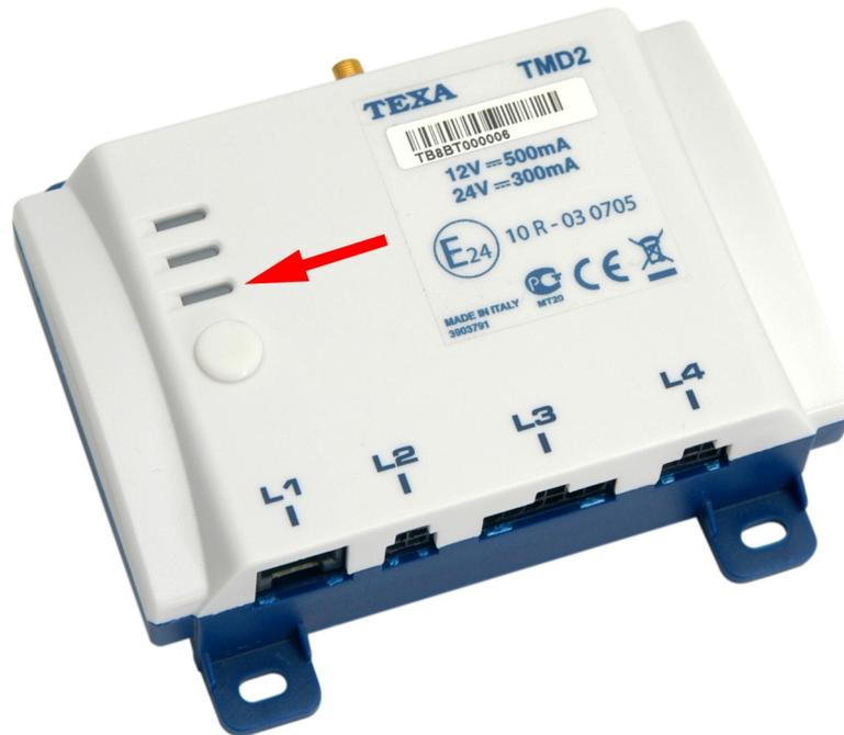
**!** No conectar el conector a TMD2 hasta que no se haya instalado todo el sistema.
