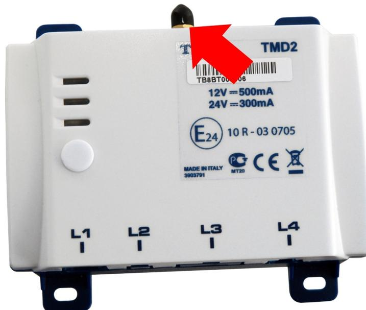
2. Introducir el conector de la antena GPS exterior en el del dispositivo ejercitando una ligera presión, hasta oír un "click".
