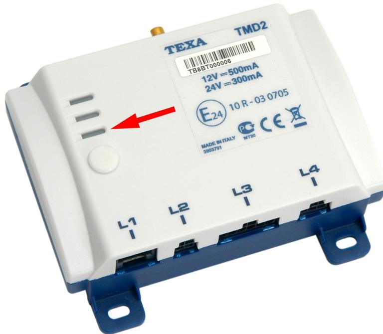
**!** Schließen Sie den Steckverbinder nicht an dem TMD2 an, bis das gesamte System vollständig ist.
