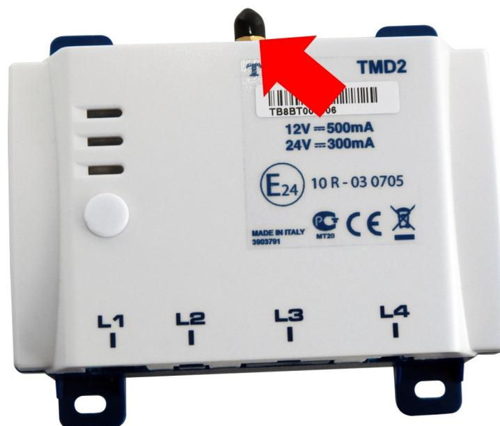
2. Führen Sie den Steckverbinder des Steckverbinders der externen GPS-Antenne in den Steckverbinder des Geräts ein, indem Sie ihn vorsichtig drücken, bis Sie ein "Klicken" hören.
