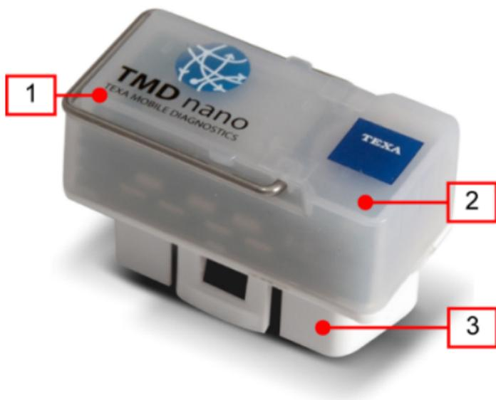
1. **Antenne Bluetooth:** permet d'établir la communication avec les dispositifs externes. \*
