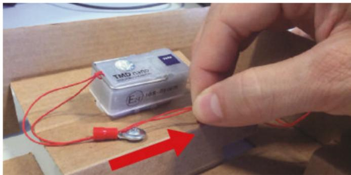
**!** Bei Bemessung der Schnurlänge ist die Position der OBD-Buchse zu berücksichtigen, da die Schnur auf keinen Fall die Betätigung der Kupplung, der Bremse und des Fahrpedals sowie die Bedienung anderer im Fahrzeug vorhandenen und zur Sicherheit und zum
