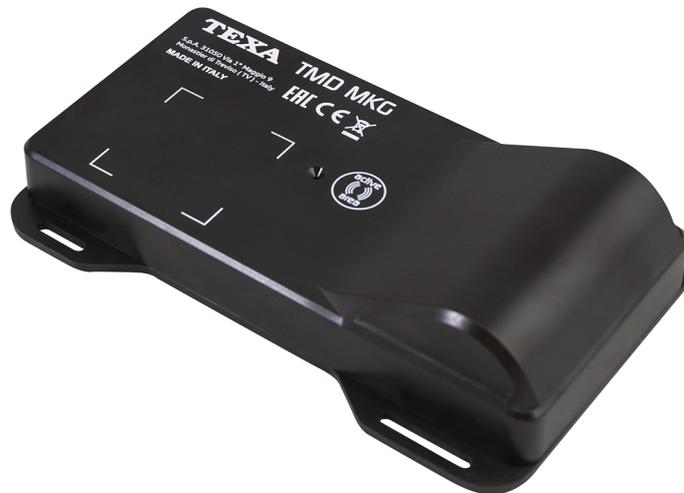
Il dispositivo funziona unicamente in abbinamento con una unità **MASTER** TEXA, alla quale è collegato mediante un canale Bluetooth Low Energy.
