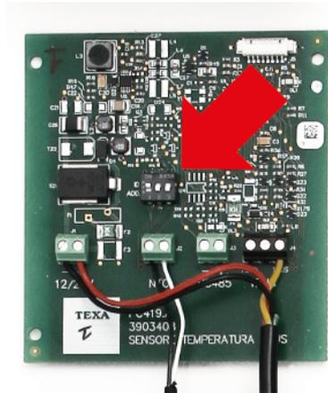
Le **Dip-Switch** est composé de trois mini-interrupteurs pour établir un code numérique au **TMD TTS** à travers la combinaison suivante ON (1) - OFF (0).
