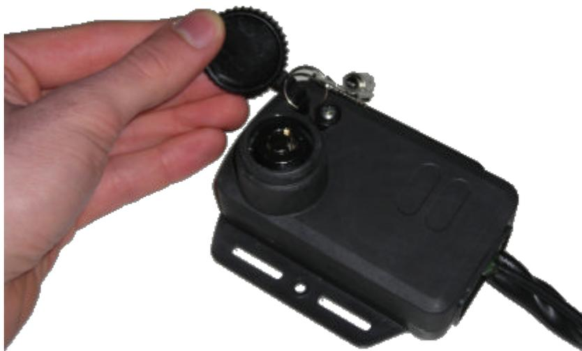
2. Insérer la clé et la tourner dans le sens contraire des aiguilles d'une montre.
